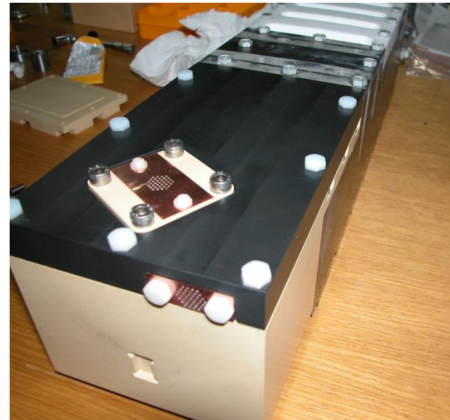
Capot et boîtier fixés sur le capteur pCO 2
